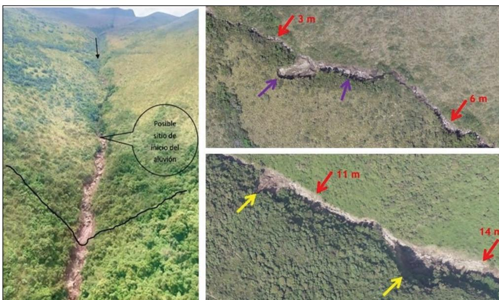
*Nota:* izquierda, evidencia de posible inicio del aluvión a aproximadamente 3600 msnm (fotografía del autor). Derecha, evidencia de pequeños deslizamientos en los segmentos alto y medio de la quebrada (3900-3600 y 3600-3200 msnm) (Andrade et al. 2022).
